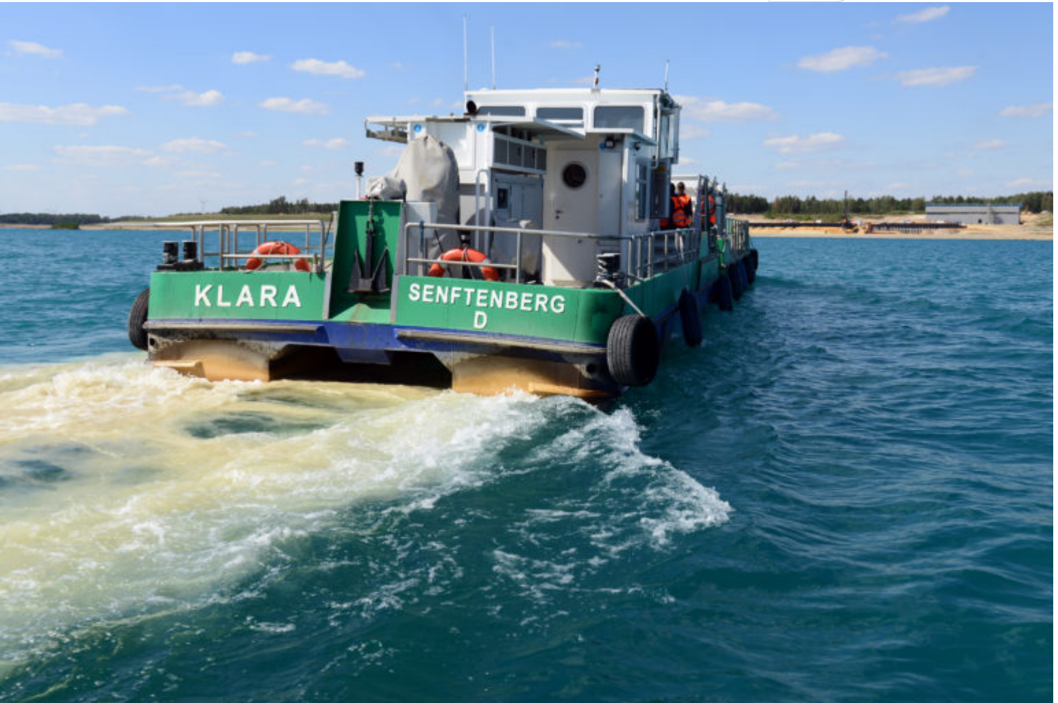
Gütemasserbehandlungsschiff der LMBV im Einsatz auf dem Sedlitzer See
