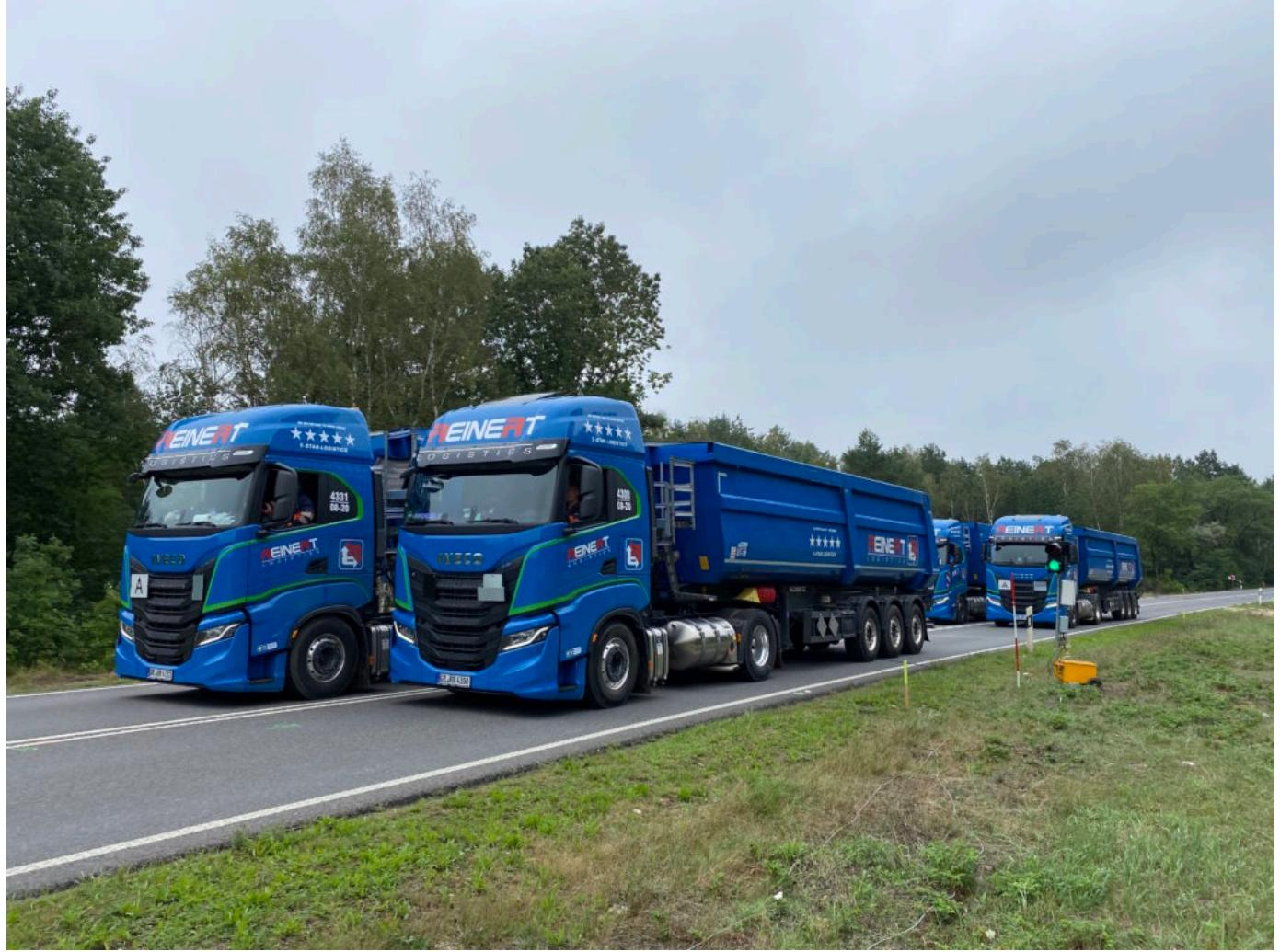
Senftenberg | Spreetal. Bei den am 1. September 2020 im Auftrag der LMBV erfolgten **ersten Belastungsfahrten mit vier voll beladenen 40 t-LKW mit verschiedenen Fahrzeuganordnungen und Geschwindigkeiten** wurden nur minimale Verformungen an aufgetretenen einzelnen Risskanten im Belag der B 97 festgestellt.
