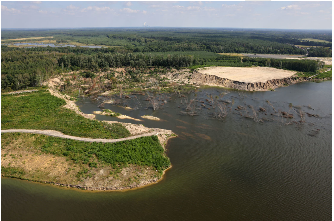
Setzungsfließen am Knappensee (2021)
