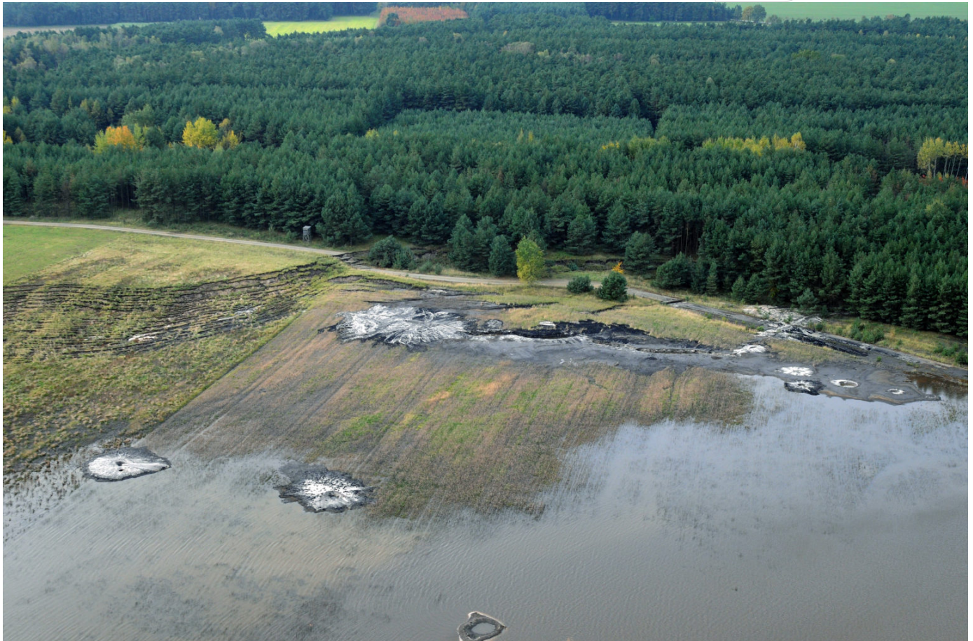
Grundbruch im Bereich Spreetal (2010)
