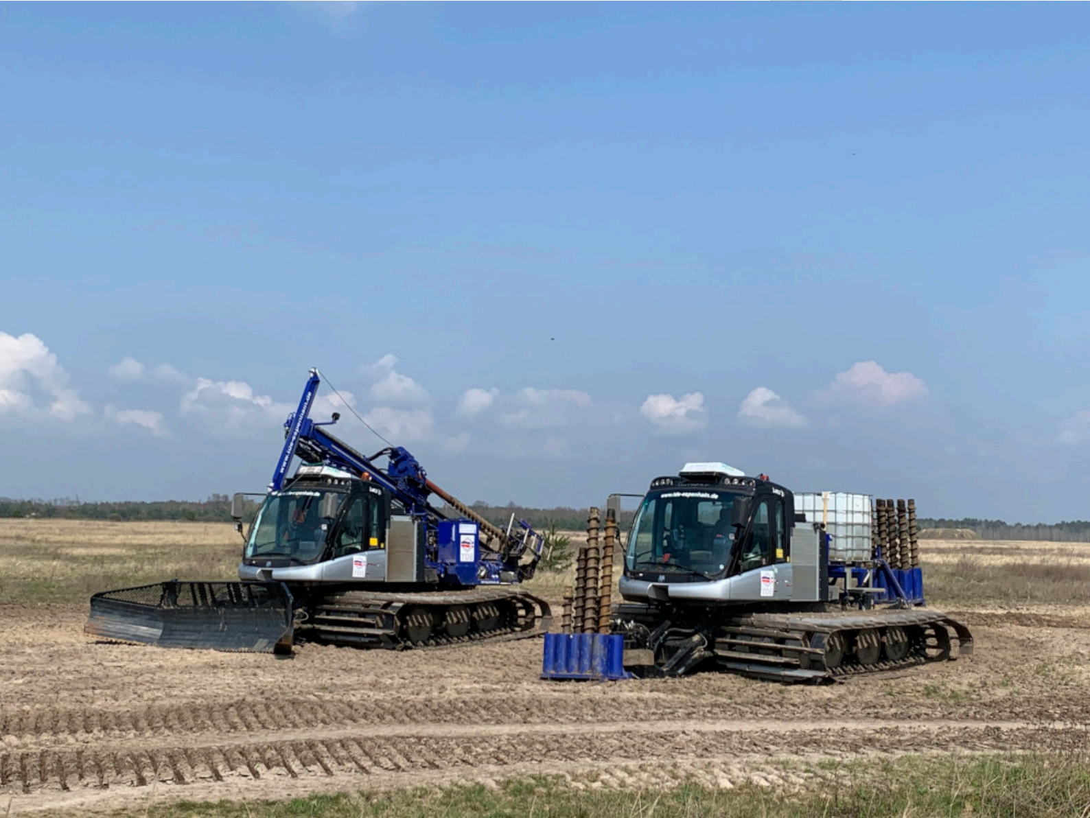
Raupengestützte Spezialtechnik der Fa. TDE zum Bohren auf Kippen
