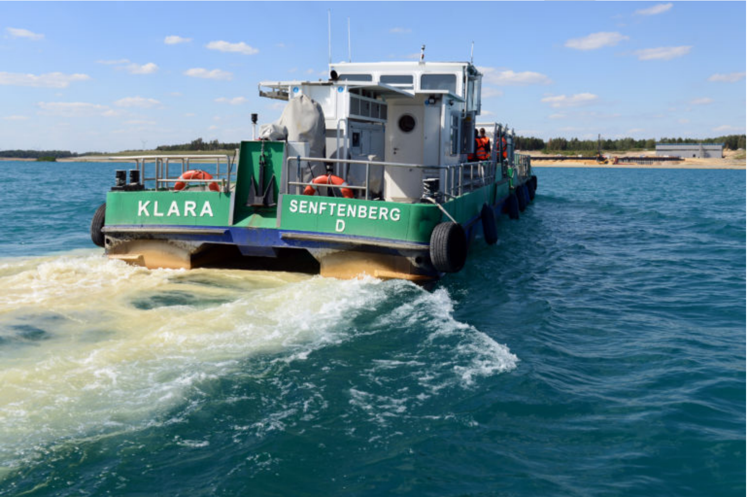
Gütemwasserbehandlungsschiff der LMBV im Einsatz auf dem Sedlitzer See
