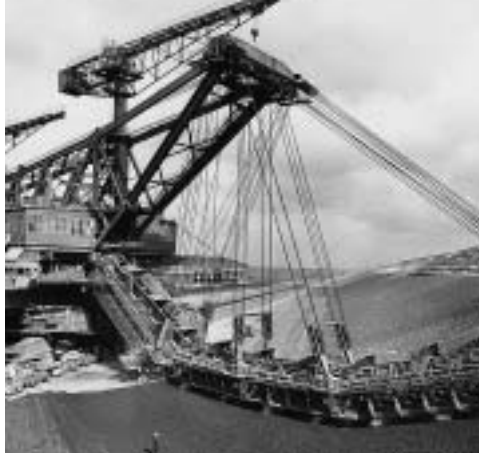
Eimerkettenbagger Es 3150 im Abraumbetrieb
