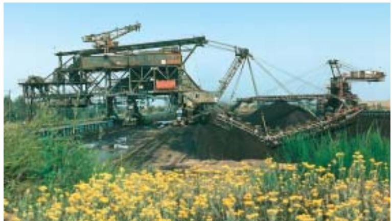
Grabenbunker mit Entnahmegerät EG 1120
