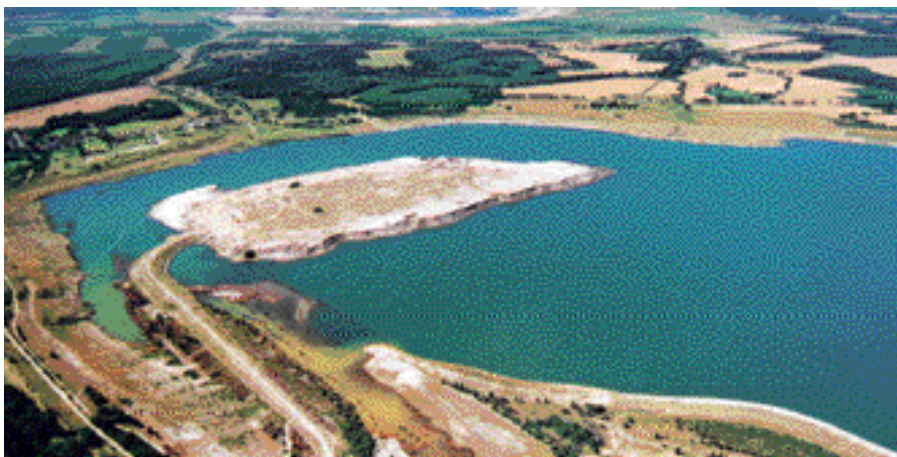
Die Insel im 470 Hektar großen Gräbendorfer See wird gesichert: Kräftige Wasserstrahlen flachen die steilen Böschungen ab.
