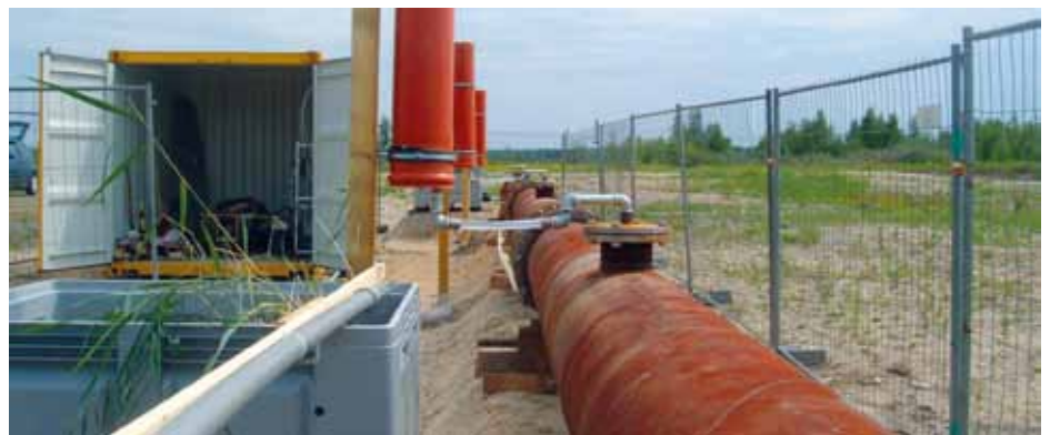
Aufbau der Versuchsanlage zur Sulfatreduktion am Nordwestufer des Hainer Sees.
