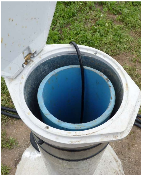
Stromkabel der eingehängten Pegelsonde (20.05.2019 am Standort 3 GWM 7645); das Einkerbten der Pegelkappe erfolgt nachträglich
