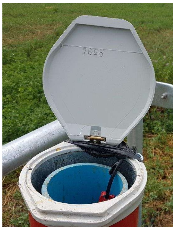
Fehlende Messstellenbeschriftung erfolgte durch den Bohrbetrieb am 07.06.2019 nachträglich
