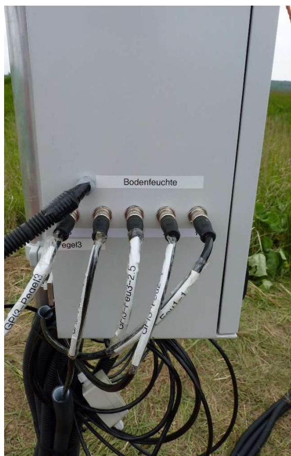
Anschluss der Saugspannungssonden am Schaltschrank
