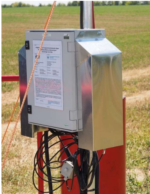
Installation einer Schutzhaube zum Schutz der Sondeneingänge am 23.07.2019
