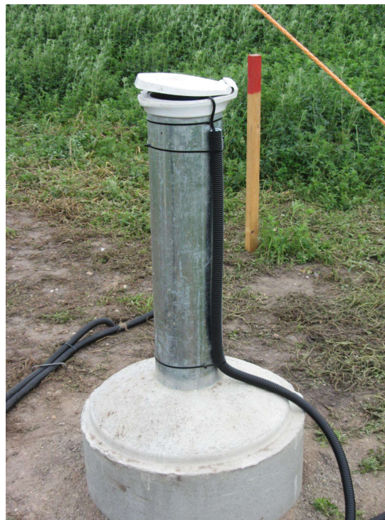
Stromkabel der eingehängten Pegelsonde (20.05.2019 am Standort 3 GWM 7645); das Einkerbten der Pegelkappe erfolgt nachträglich
