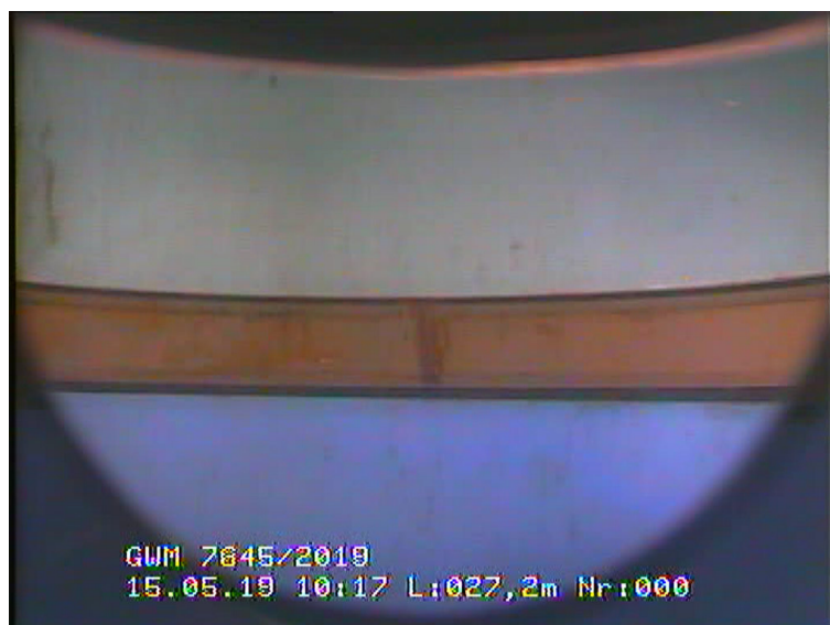
Detailaufnahme GWM 7645/2019 Filteroberkante bei 27,2 m (horizontale Sicht)
