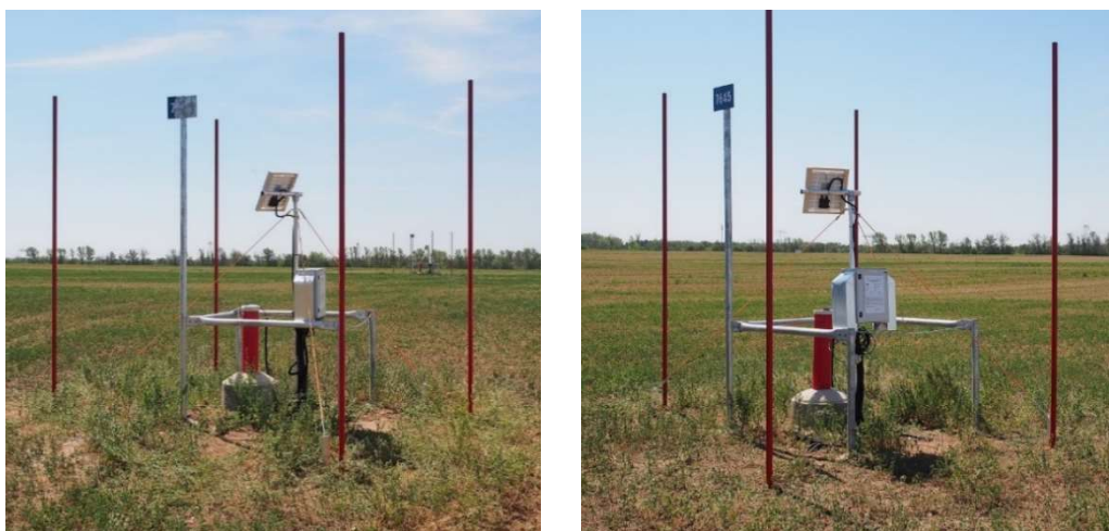
Abb. 2 Neu errichtete Sondermessstellen am Standort 2 (GWM 7642) und 3 (GWM 7645) mit Anfahrschutz und Markierungsstangen am 23.07.2019
