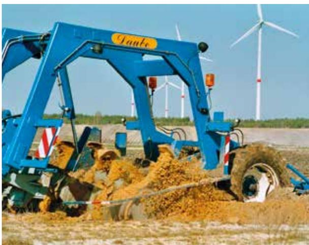
Kalkeinarbeitung mittels einer Tiefspatenfräse
