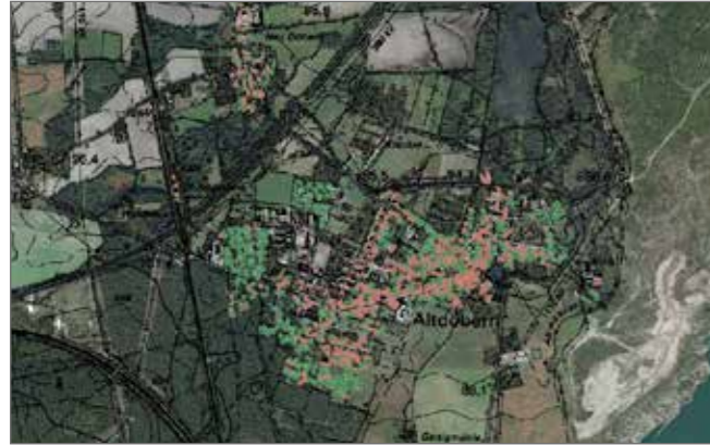
448 Grundwasseranstieg betroffene Gebäude in Altdöbern, davon 250 gefährdete Wohngebäude
