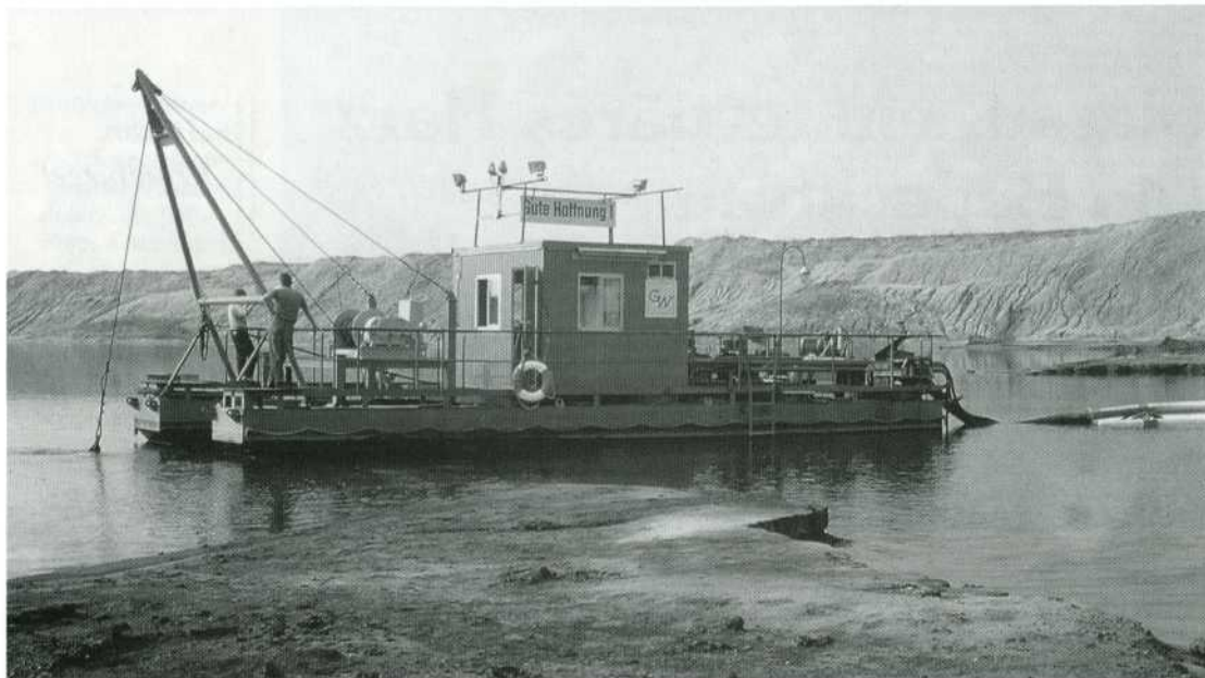
Abb. 2: Gewinnung des Bernsteins und anderer fossiler Harze, u. a. Glessit, im umweltfreundlichen Unterwasserabbau mit einem Schwimmbagger im Tagebau Goitsche bei Bitterfeld. Foto: G. Krumbiegel 1992
