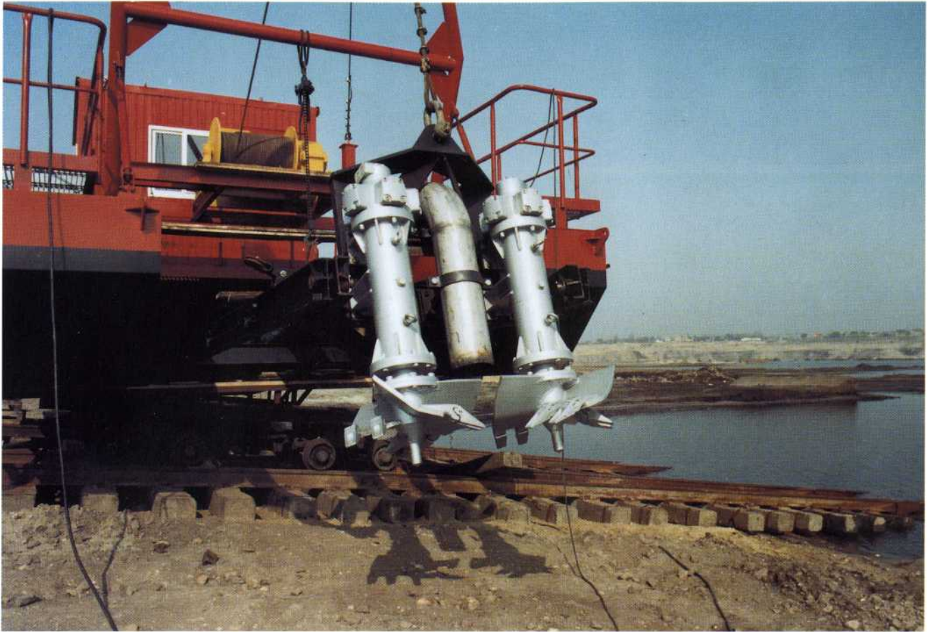
Schwimmbagger mit Auflockerungsflügel und Saugrüssel zur Schluffgewinnung unter Wasser 1991. Die Versuche wurden wegen Unwirtschaftlichkeit aufgegeben. (Foto: R.Bär)
