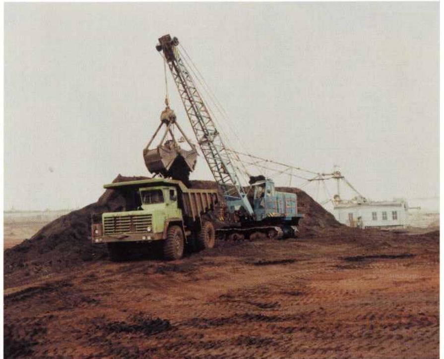
Beladen mit Greiferbaggern. Im Hintergrund werden die Schluffmassen mit einem Schürfkübel-Schreitbagger aufgehaldet (Schwenkradius ca. 120m). (Foto: R. Bär)
