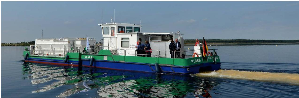
**Abb. 12: LMBV-Gewässerbehandlungsschiff „Klara“ beim Probetrieb (Quelle: LMBV)**
