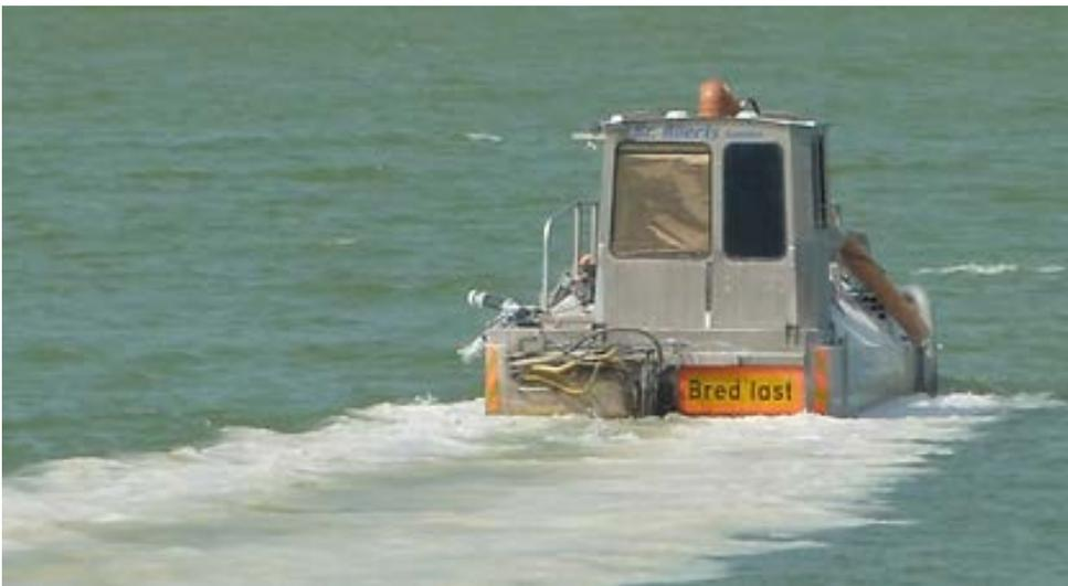
**Abb. 8:** Gewässerbehandlungsschiff „Brahe II“ mit Unterwasseraustrag (Quelle: [33])
