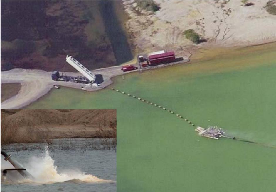
**Abb. 5: Soda-Eintrag in den Bockwitzer See (Quelle: BGD/LMBV)**
