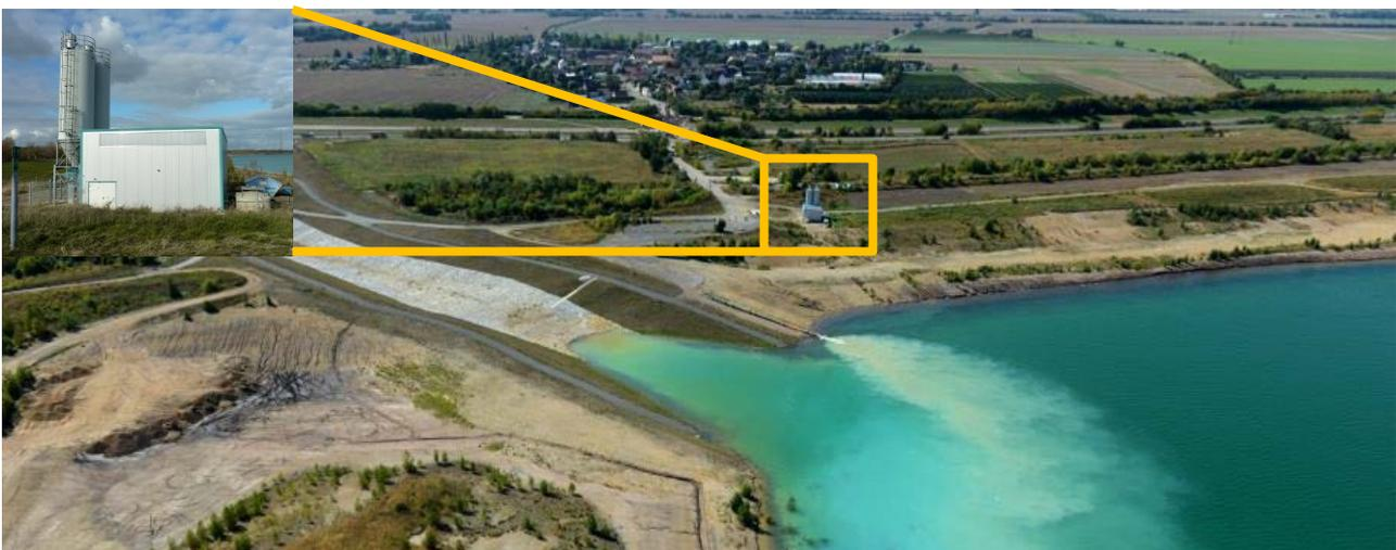
**Abb. 15: Stationäre Neutralisationsanlage am Zwenkauer See und Ausbreitung der Kalkfahne im See mit dem Flutungswasser (Quelle: LMBV)**
