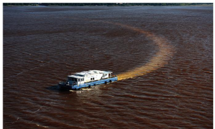
Der Schlabendorfer See wird mittels eines Sanierungsschiffes neutralisiert, 2013.
