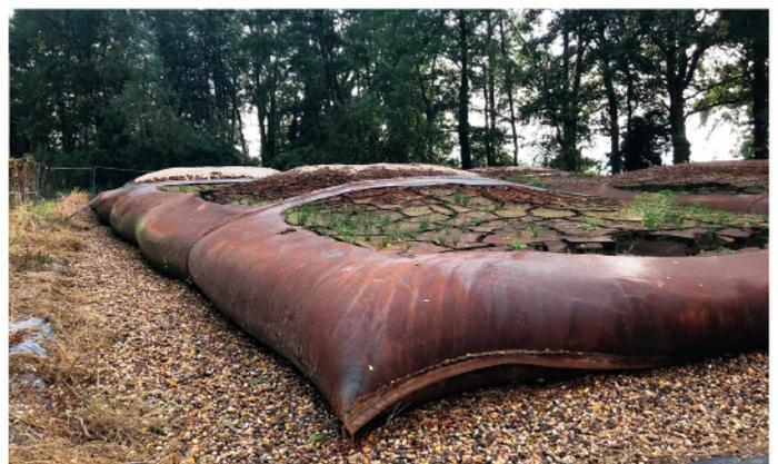
*In den Geotubes, wie in Ragow, wird der Eisenhydroxidschlamm getrocknet und später abtransportiert, 2018.*
