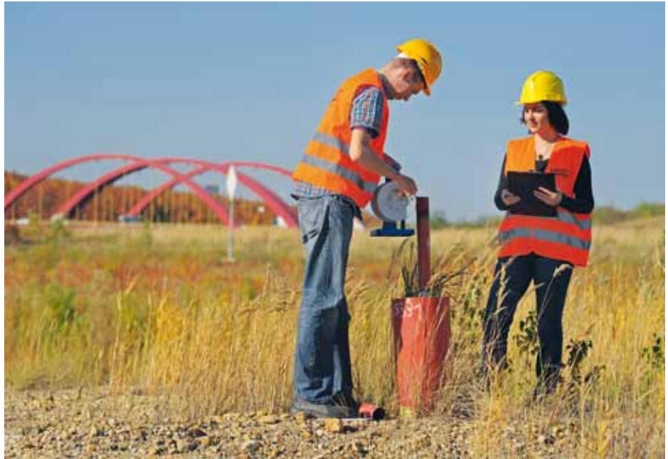
Pegelmessung an einer Grundwassermessstelle im mitteldeutschen Revier.
