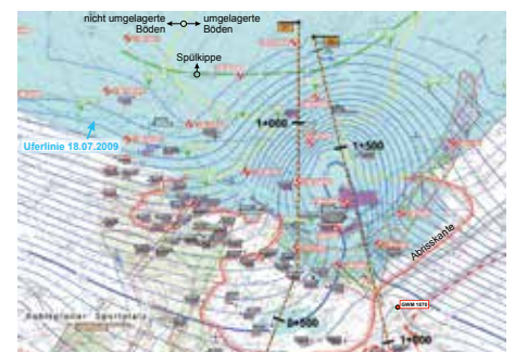
Druckblase unter dem Rutschungskessel infolge der nunmehr identifizierten hydrogeologischen Anomalie im Grundwasserleiter GWL 6.3
