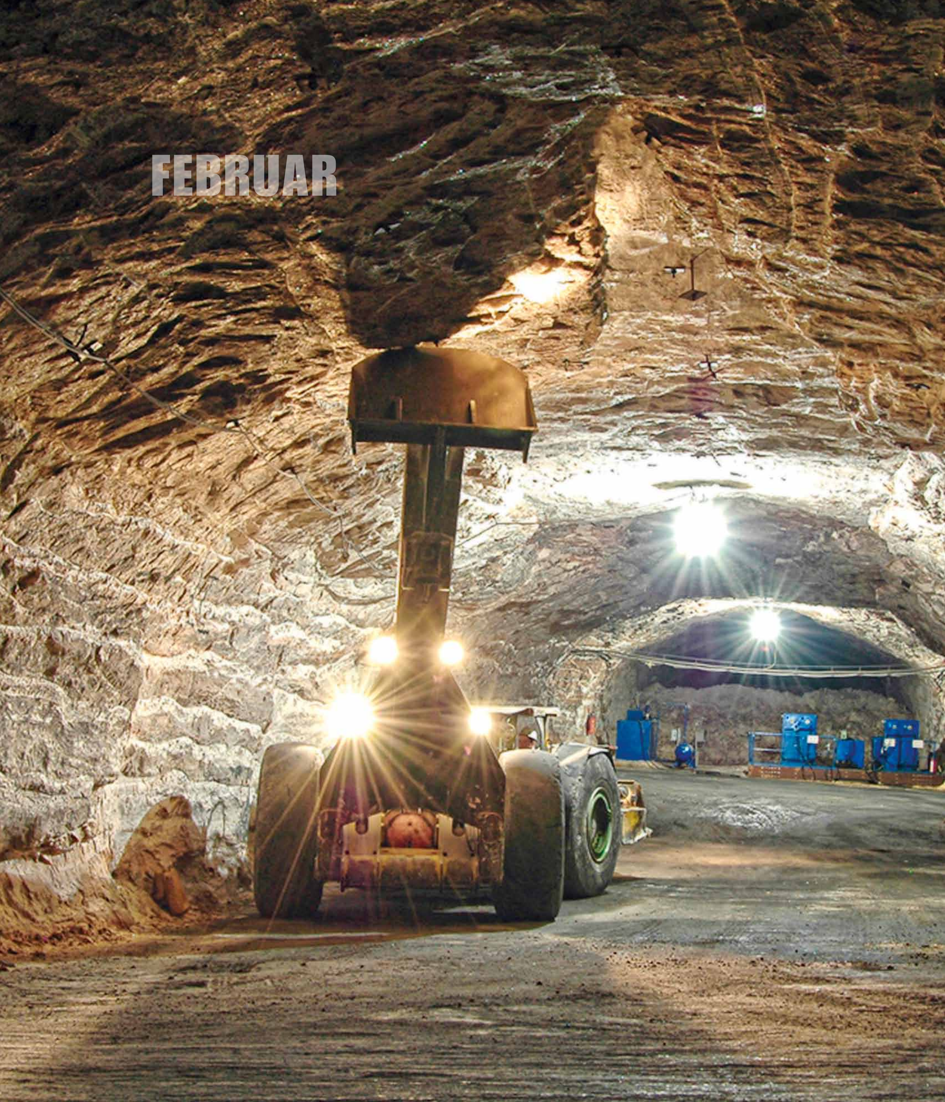
Beraubegerät beim Prüfen der Firste im Kalibergbau des Südharzreviers
