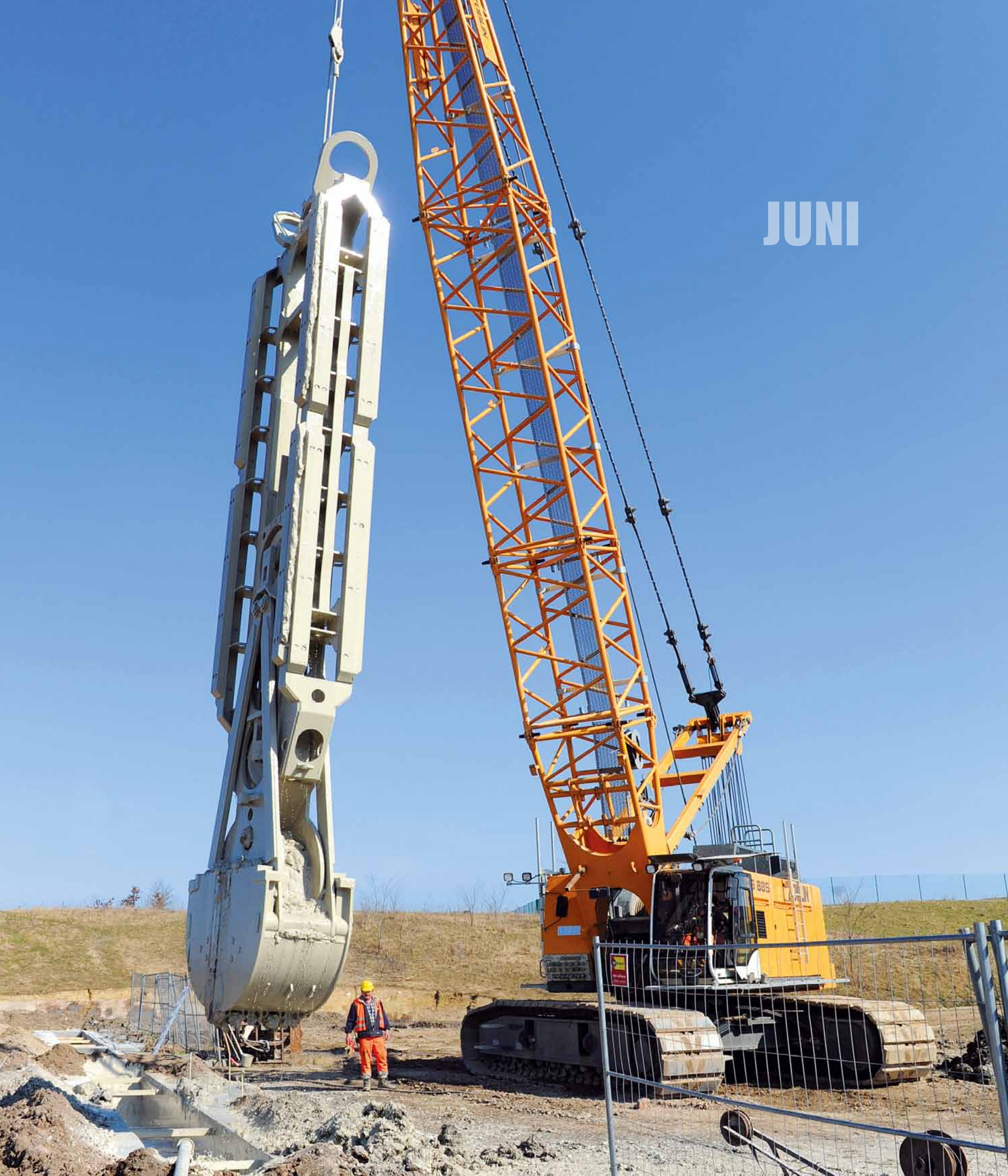
Schlitzwandbagger mit Seilgreifer zum Bau einer unterirdischen Schlitzwand am Markkleeberger See
