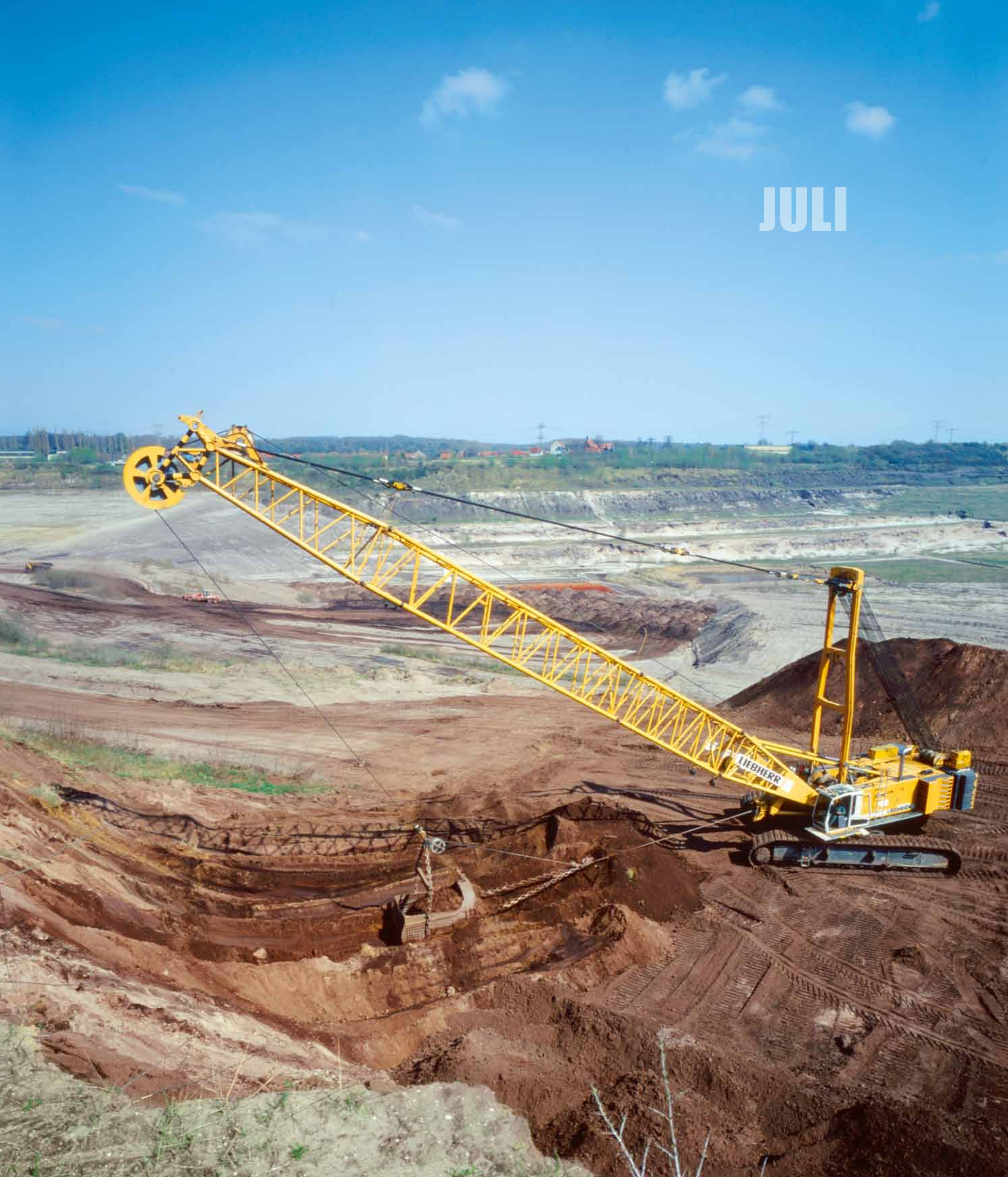
Seilbagger mit Schürfkübel bei der Sanierung der Uferböschungen im Restloch Wulfersdorf, dem entstehenden Lappwaldsee
