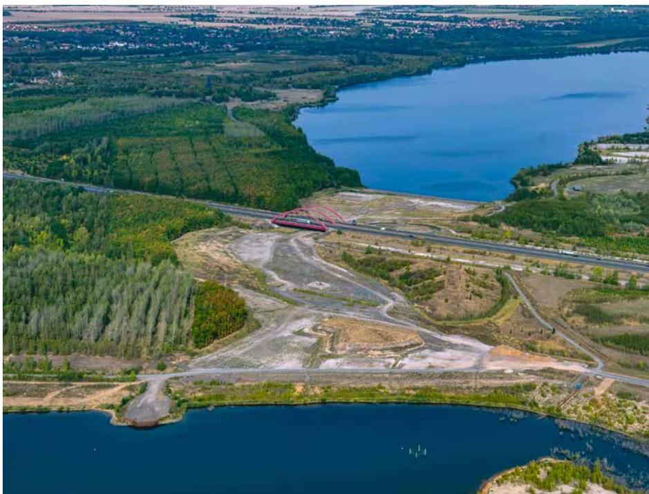
Die Auflastschüttungen am zukünftigen Harthkanal werden aktuell zurückgebaut.
