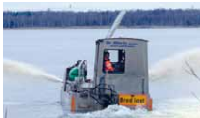
Sanierungsschiff bekalkt den Bernsteinsee.
