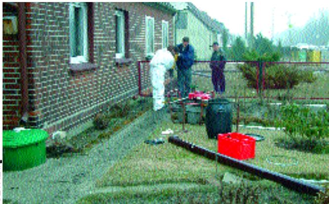
Mitarbeiter der Firma Lobbe Spremberg setzen Pegel für Bodenluftmessungen des Hygieneinstitutes Cottbus.
