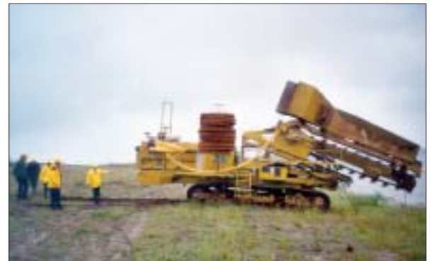
Diese Tiefenfräsmaschine der Firma KOOP GmbH wurde im Restloch Döbern genau unter die Lupe genommen.
