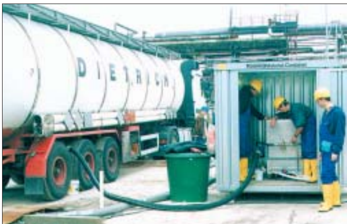
Mitarbeiter des Grundwasserforschungsinstituts Luckner & Partner GmbH Dresden injizieren Alkohol ins Testfeld.
