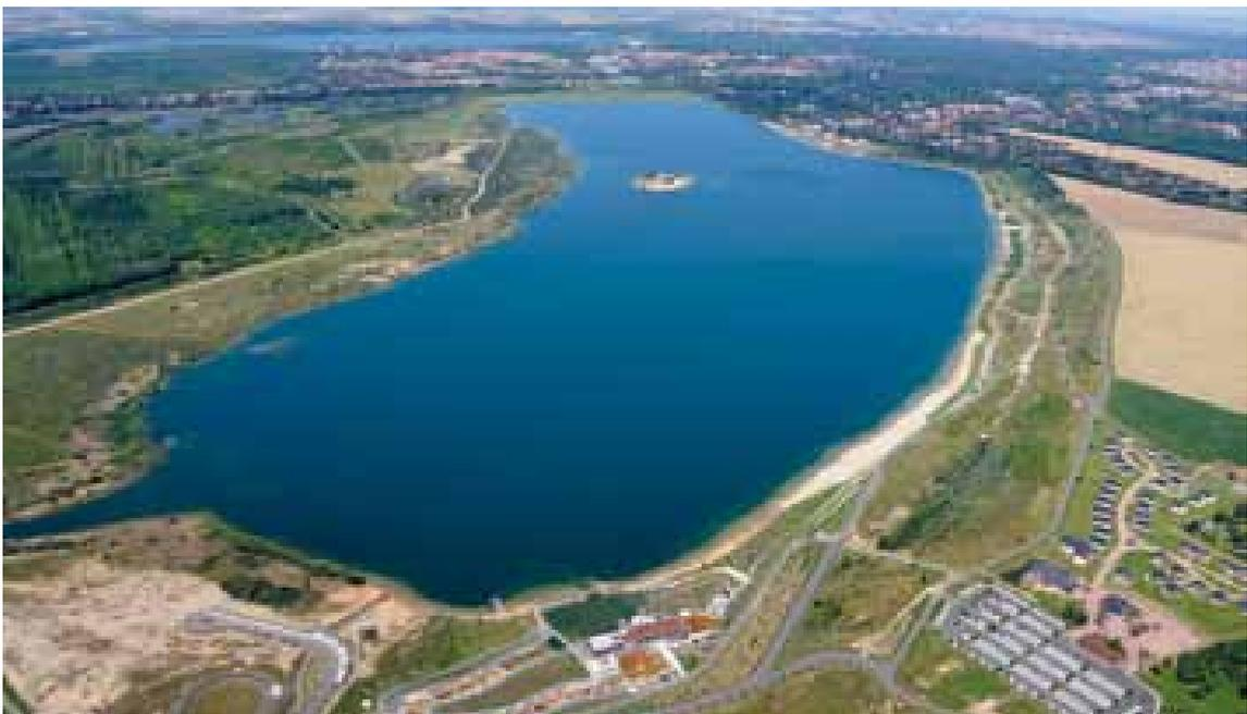
Der Wasserspiegel im Restloch **Delitzsch-Südwest** wurde durch Einleitung von 0,4 Mio. Kubikmeter zur weiteren geotechnischen Sicherung der Ufer- und Böschungsbereiche bei ca. 97,7 Meter NHN gehalten. Der weitaus größte Teil der aus der Luppe übergeleiteten Flutungsmengen – rund 90 Prozent – wurde zur Sicherung des Mindestabflusses im Bereich der Loberaue genutzt.
