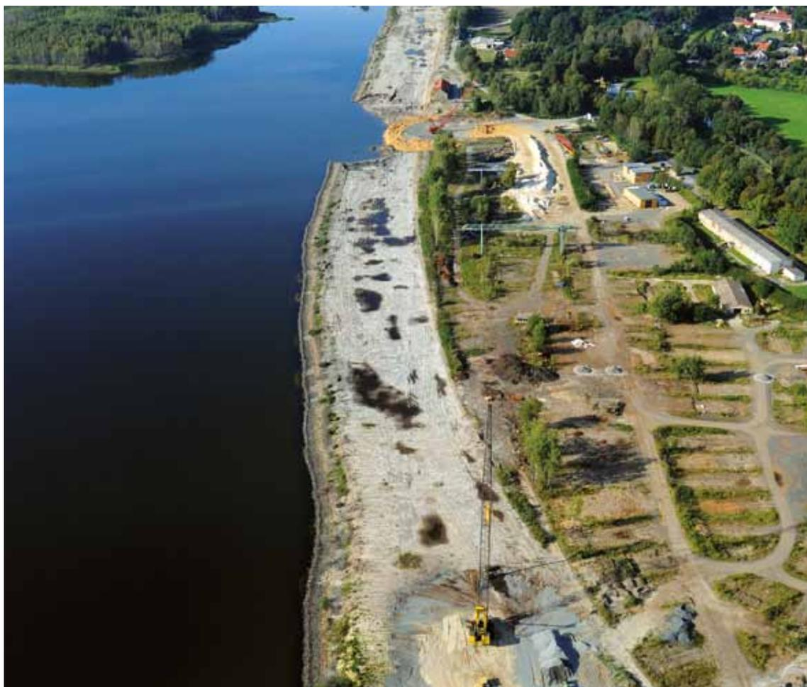
Silbersee – Aufgefüllter Bereich der Rutschung im mittleren Abschnitt des Ostufers bei Lohsa
