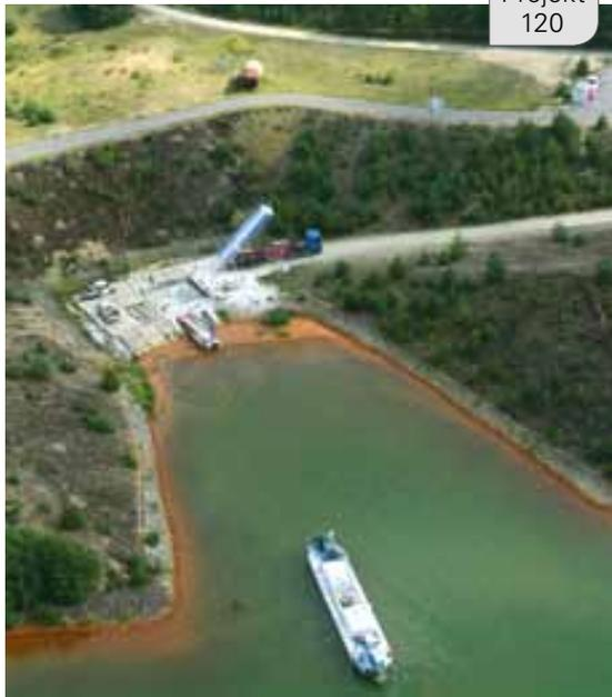
Im Jahre 2012 konnte durch die Fortführung der Konditionierung des Wasserkörpers Burghammer mit dem Einbringen von ca. 3.500 t Kalk mittels Sanierungsschiff die Gewährleistung der Ausleitbedingungen in die öffentliche Vorflut realisiert werden.
