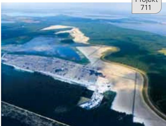
Auf zwei Teilflächen im Lugteichgebiet bei Laubusch konnte durch Massenauftrag mit einer trockenen Überdeckung die geotechnische Sicherung abgeschlossen werden. Es wurden auf 30 ha Fläche ca. 650.000 m<sup>3</sup> Erdstoff aus der benachbarten Hochkippe eingebaut.
