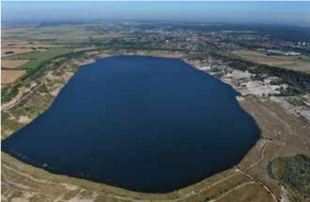
Die Fremdflutung des **Restloches Helmstedt** zur Herstellung des Lappwaldsees bei Helmstedt erfolgt mit Sumpfungswasser aus dem Tagebau Schöningen durch die MIBRAG mbH. Es wurden 2,26 Millionen Kubikmeter Sumpfungswasser zugeführt.
