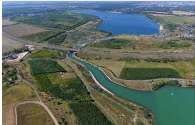
Die Flutung des **Restloches Nachterstedt** kann erst nach Abschluss der Böschungssanierung wieder aufgenommen werden. Zur Haltung des sanierungsbedingten Grenzwasserspiegels von + 85,0 Meter NHN wurden im Berichtszeitraum 5,3 Millionen Kubikmeter in die Selke abgeleitet. Zusätzlich wurden zur Sicherung der Böschungsstabilität mittels Filterbrunnen circa 3,1 Millionen Kubikmeter Grundwasser entnommen und ebenfalls in die Selke abgeführt.
