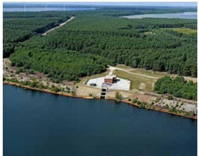
Die aus der Kleinen Spree in das **Restloch Dreiweibern** eingeleitete Menge von 4,3 Millionen Kubikmeter wurde zu 40 Prozent zur Weiterleitung zum SB Lohsa II genutzt. Die übrigen 2,5 Millionen Kubikmeter dienen zur Anhebung des Wasserspiegels von 116,54 auf 117,43 Meter NHN.
