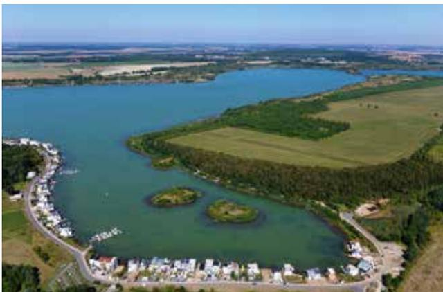
In das **Restloch Störmthal** wurden mit 3,7 Millionen Kubikmeter etwa 24 Prozent des Profener Wassers zur Beschaffheitsnachsorge eingeleitet. Dies entspricht circa 17 Millionen mol bzw. einer Ersparnis von circa 1.200 Tonnen Kalksteinmehl. Das Überschusswasser wurde über die Kanupark-Schleuse zum Markkleeberger See abgeleitet.
