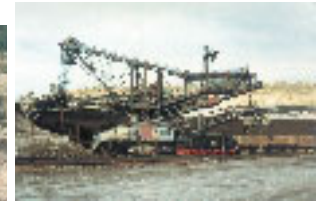
Böschungsanstützung mit Absetzer 966 A900 - Süd- böschung Südfeld 1997
