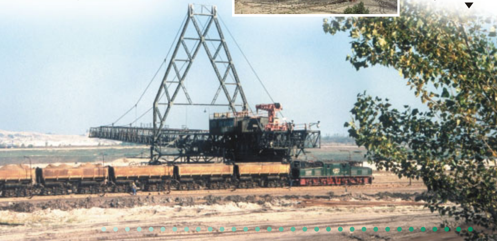
Böschungsanstützung mit Absetzer 966 A900 - Süd- böschung Südfeld 1997
