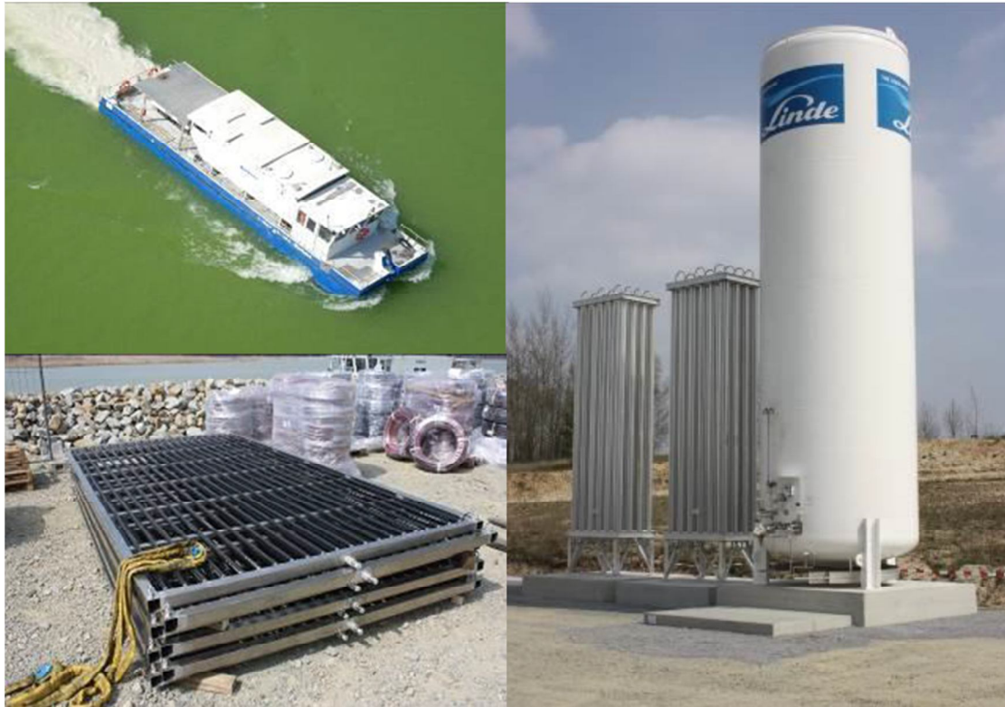
Abb. 5.2.1: Bekalkungsschiff während des Einsatzes (oben), Begasungsrahmen vor dem Einbau (unten) und CO 2 -Tank mit zwei Verdampfeinheiten (rechts)
