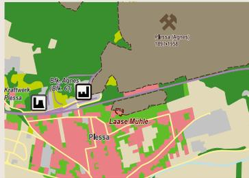
Nachdem Plessa 1885 an die Bahnstrecke Kohlfurt-Falkenberg angeschlossen worden war, begann 1897 der Abbau im Tagebau „Agnes“, in dem ab 1924 die erste Abraumförderbrücke der Welt in Betrieb ging. Der Tagebau überbaggerte u. a. das Laase-Quellgebiet. Am nördlichen Ortsrand von Plessa wurde 1901 die Brikettfabrik Agnes und ab 1926 das Kraftwerk Plessa errichtet.
