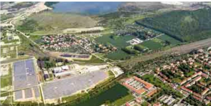
In der Nähe von Merseburg entstand auf dem Areal der früheren Brikettfabrik Beuna bis Ende 2011 der **Solarpark Beuna**. Das auf einer Gesamtfläche von rund 10 Hektar von der Servicegesellschaft Sachsen-Anhalt-Süd errichtete Sonnenkraftwerk verfügt über eine Leistung von 4,3 MWp. Betreiber des Parks ist die SOLSA Solarenergie Sachsen-Anhalt GmbH, eine Tochter der Stadtwerke Bernburg und Merseburg.
