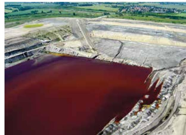
*2006 sind die Anlagen zur Flutung des Restloches Zwenkau an der B186 bei Zitzschen fertiggestellt. Das Wasser weist damals pH-Werte unter 3 und hohe Eisengehalte auf.*
