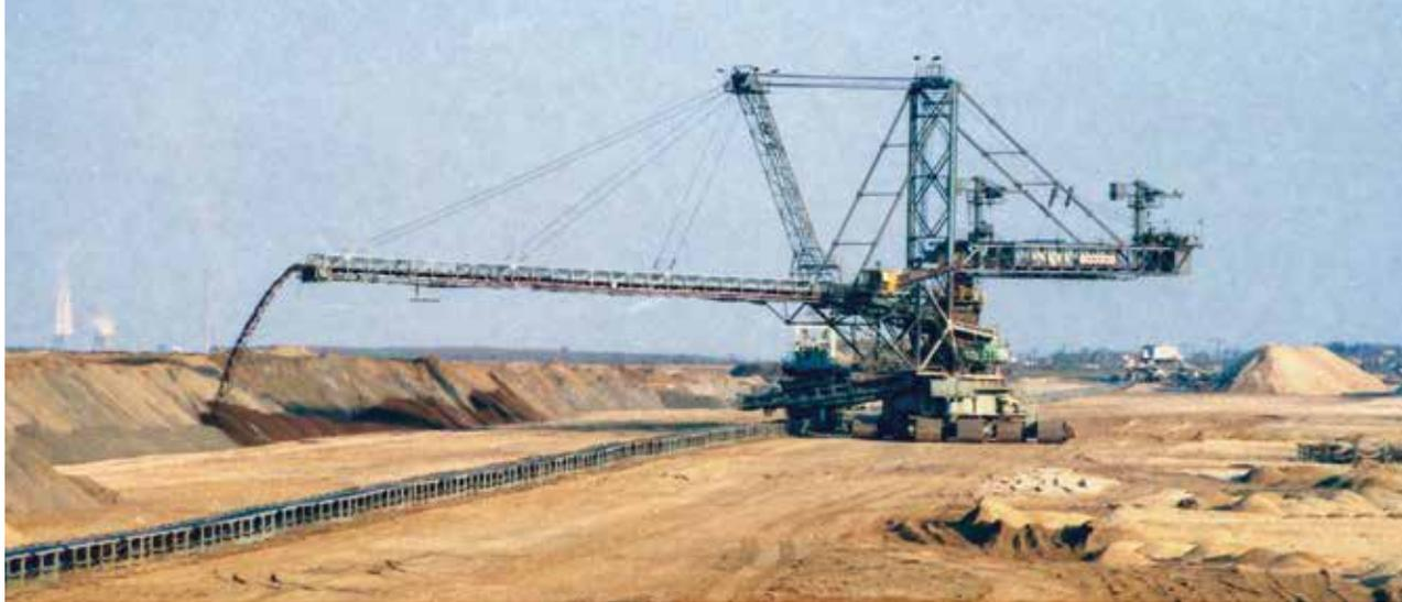
Die Bandanlagen und ein Teil der Tagebaugroßgeräte, wie hier im Bild der Bandbetriebsabsetzer 1113 A<sub>2</sub>Rs-B 7200, wurden 1994 zur Optimierung der Wiedernutzbarmachung bis zur Betriebseinstellung in den Tagebau Zwenkau umgesetzt. Im Hintergrund das Kraftwerk Thierbach, 1997
