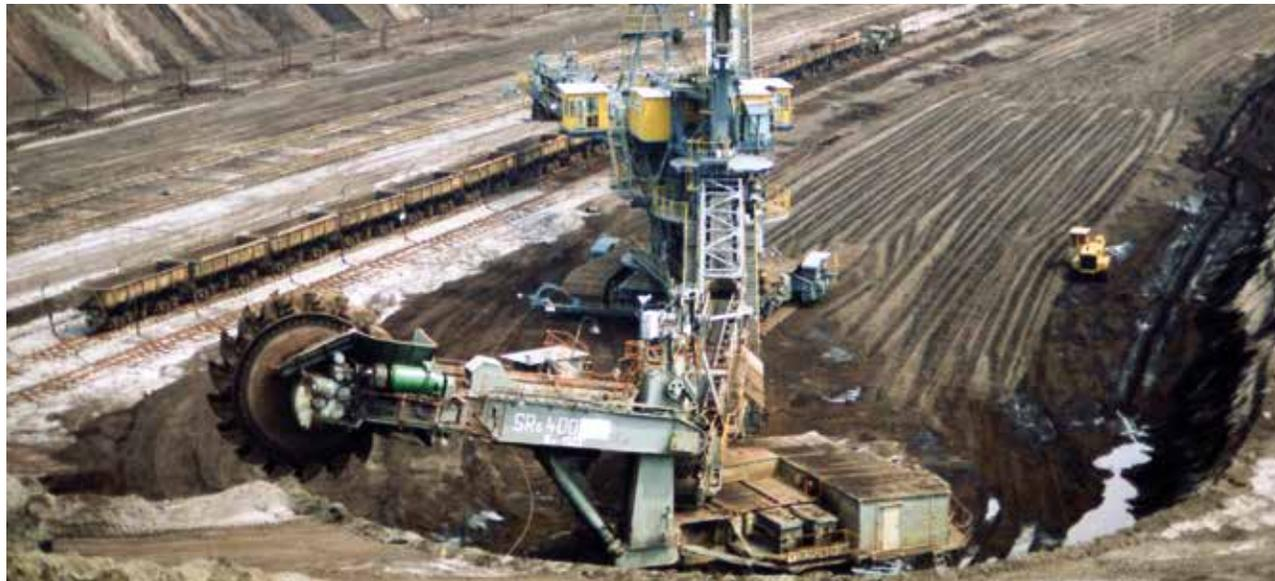
Nach Abschluss der Böschungsabflachungsarbeiten im Tagebau Cospuden wurde der Bagger 1529 SRs 400 in den Mittelschnitt des Tagebaues Zwenkau umgesetzt und mit dem Bandwagen 826 BRs 1400 mit Zugverladung betrieben. Dadurch konnte der alte Bagger 1443 SRs 500/630 verschrottet werden, 1995.
