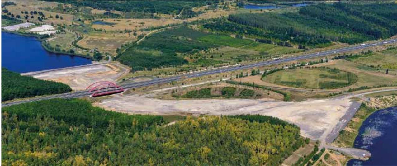
*Geotechnisch erforderliche und durch Rüttelstopfverdichtung sowie Auflastschüttungen erreichte Baugrundverbesserungen im Bereich der Trassenführung für den geplanten Gewässerverbund zwischen Zwenkauer und Cospudener See wurden 2016-2018 ausgeführt, August 2016.*
