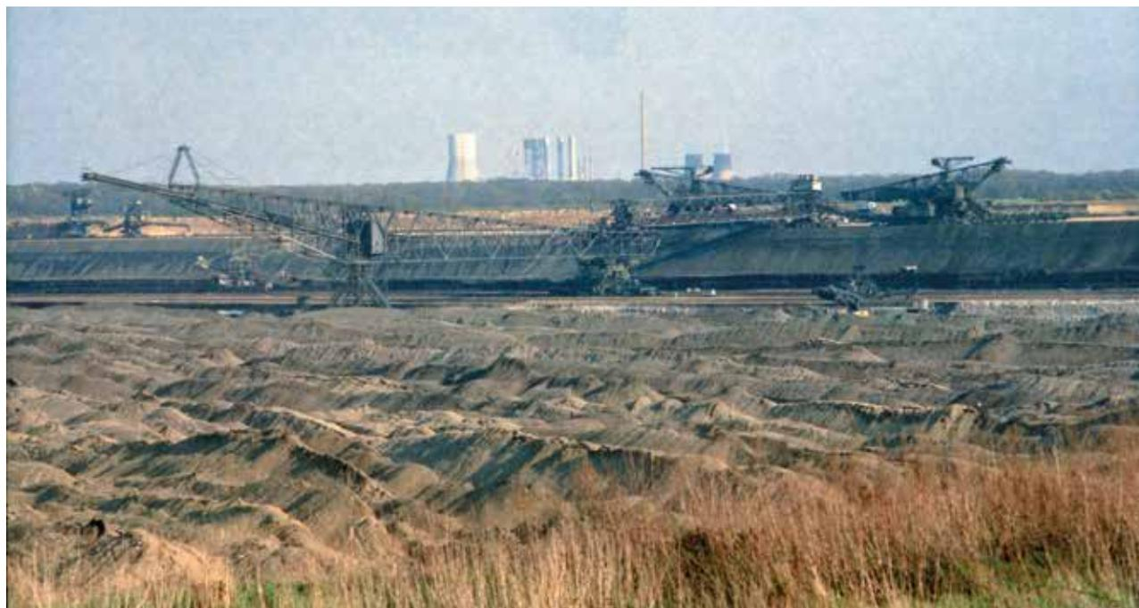
*AFB 18 mit auf den Brückentiefschnitt reduzierter Abtragsmächtigkeit und vorlaufendem Bandbetrieb im vereinigten Vorschnitt und ehemaligen Brückenhochschnitt, im Hintergrund die Baustelle des Neubaukraftwerks Lippendorf und das noch bis 1999 in Betrieb befindliche Altkraftwerk, 1997*
