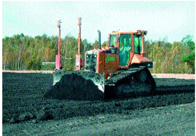
Mittels Lasermesstechnik an der Planierraupe wird die vorgegebene Schichtstärke der kontaminierten Massen beim Einbau kontrolliert.
