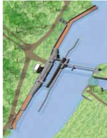
Schleusenanlage mit Borsten-Fischpass.
