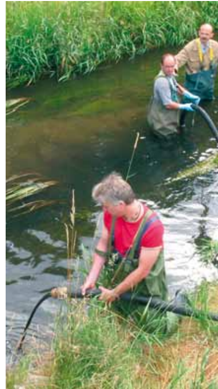
Mitarbeiter vom Ingenieurbüro Melioplan bei der Untersuchung der Kolmationsschicht im Lober.
