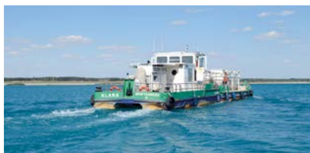
Wasserbehandlungsschiff der LMBV „Klara“ im Einsatz
