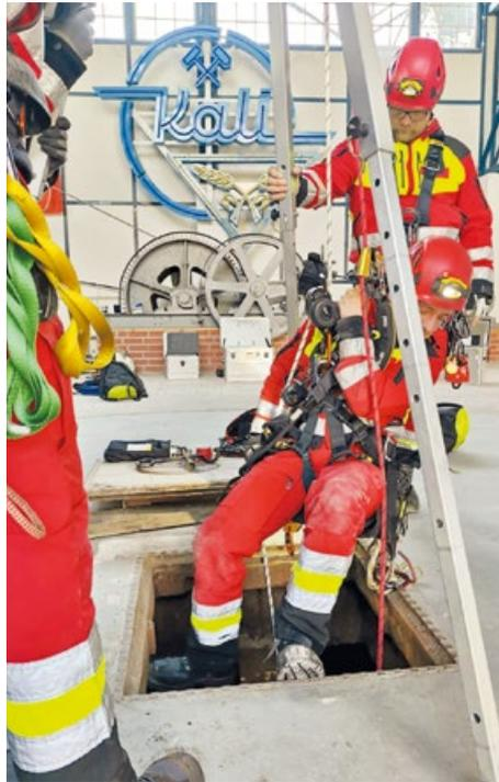
*Dreibock auf der Ackersohle: Kontrolle der Verfüllsituation durch die Grubenwehr.*
