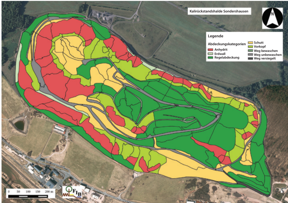
Abb. 11.2. Abdeckung der Hydrotöpfe im Istzustand am Beispiel der Kalirückstandshalde Sondershausen Quelle: FIB 2019
