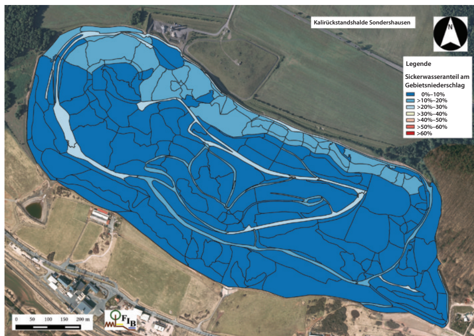
Abb. 11.5. Reduzierung des Sickerwassers mit Haldenschutzwald am Beispiel der Kalirückstandshalde Sondershausen Quelle: FIB 2019
