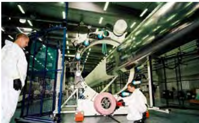
Montage von Rotorblättern bei Vestas
