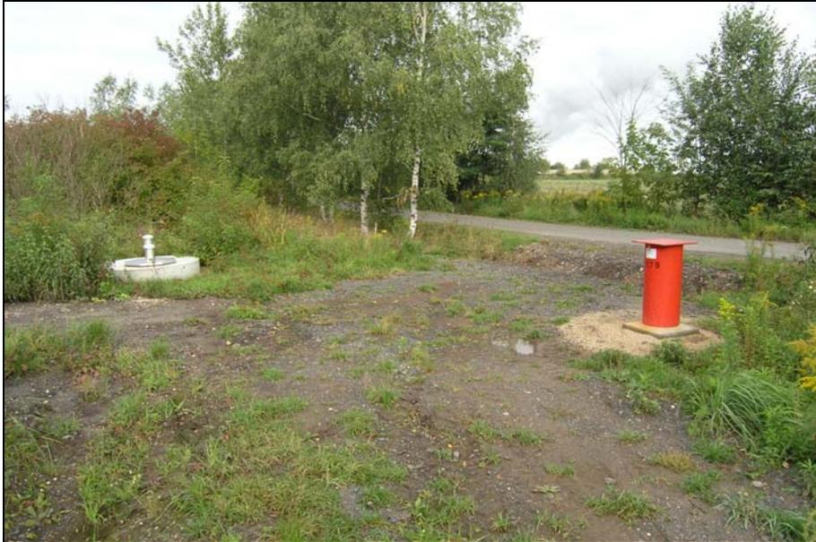
**Abbildung 12:** Messschacht Bodensickerwasser/Bodenluft sowie mehrfachverfilterte Grundwassergütemessstelle M1
