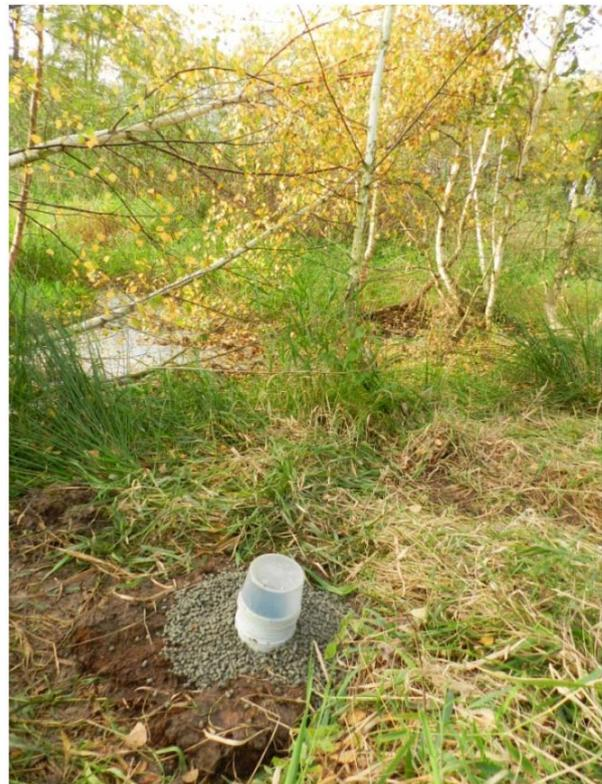
**Abbildung 18:** Schematische Darstellung Sickerwassermessstelle, Foto der Sickerwassermessstelle SW C1 [3c]
