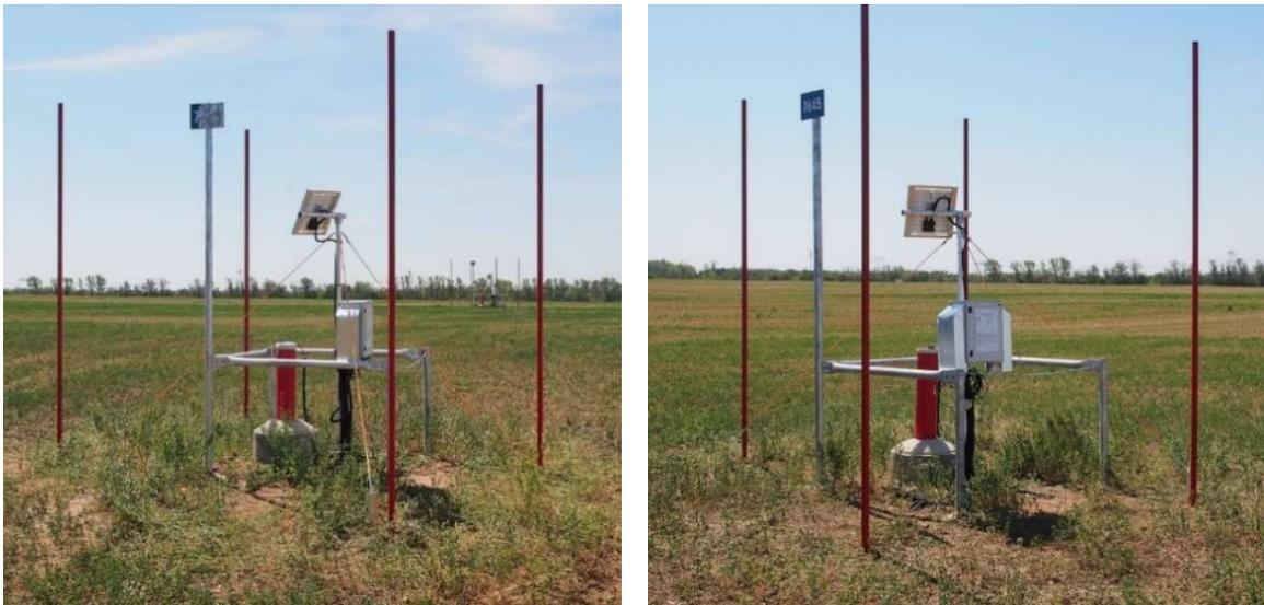
**Abb. 5-2** Neu errichtete Sondermessstellen am Standort 2 (GWM 7642) und 3 (GWM 7645) mit Anfahrschutz und Markierungsstangen am 23.07.2019
