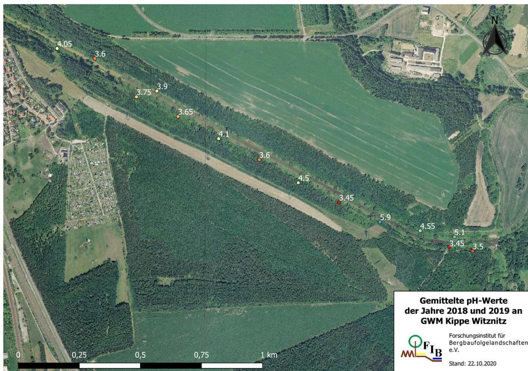
Abbildung 8: pH-Werte in den Grundwassermessstellen entlang der Pleiße im Bilanzgebiet 4
