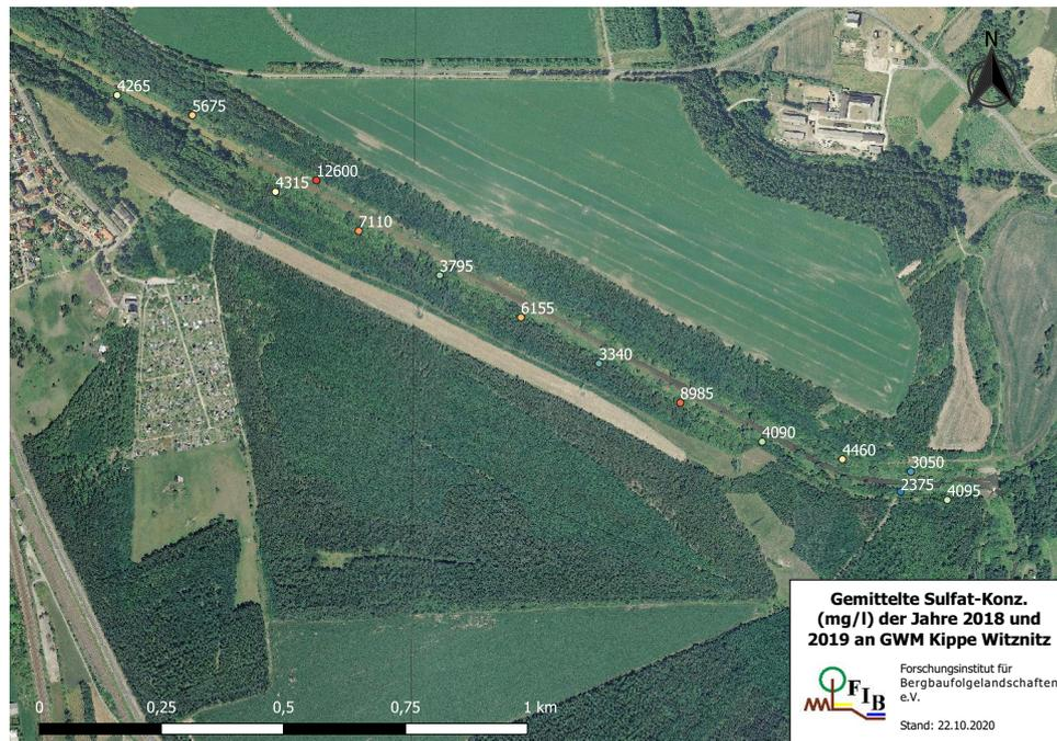
Abbildung 6: Sulfatkonzentrationen in den Grundwassermessstellen entlang der Pleiße im Bilanzgebiet 4
