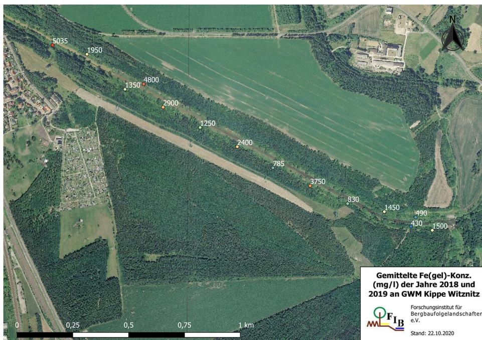
Abbildung 5: Eisenkonzentrationen in den Grundwassermessstellen entlang der Pleiße im Bilanzgebiet 4
