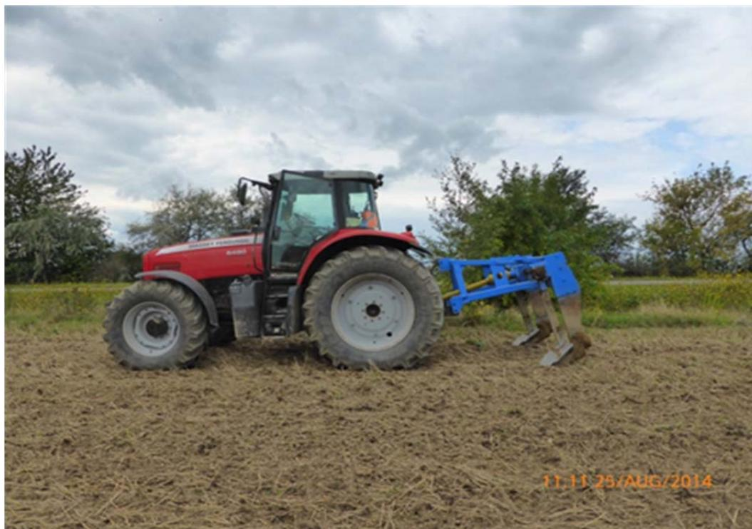
**Bild 1: Stechhublockerer auf Fläche C am 25.08.2014**
