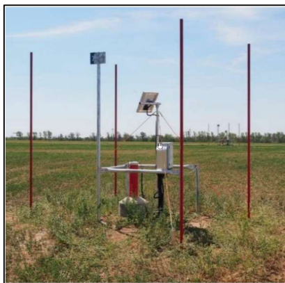
Abbildung 4-5: neu errichtete Sondermessstelle Standort 2 (GWM 7642), schematischer Aufbau der Messeinrichtung [9n, Auszug]
