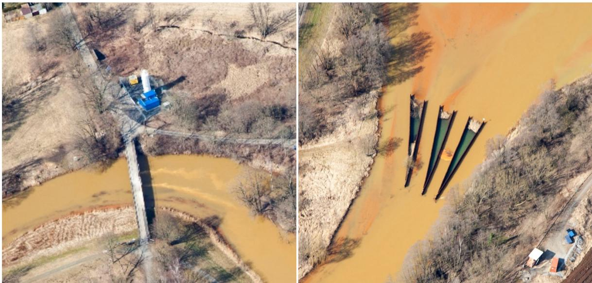
**Bild 1:** Wasserbehandlungsanlage an der Spree mit Kalkstation (TA 1, links) und Dosierstelle für das Flockungshilfsmittel am Verteilerbauwerk der Vorsperre Bühlow (TA 2, rechts). (Fotos: Rauhut, März 2018).
