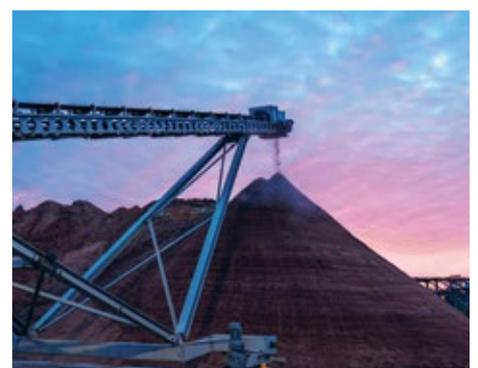
Schüttkegel mit gereinigtem Boden in der VTRA
