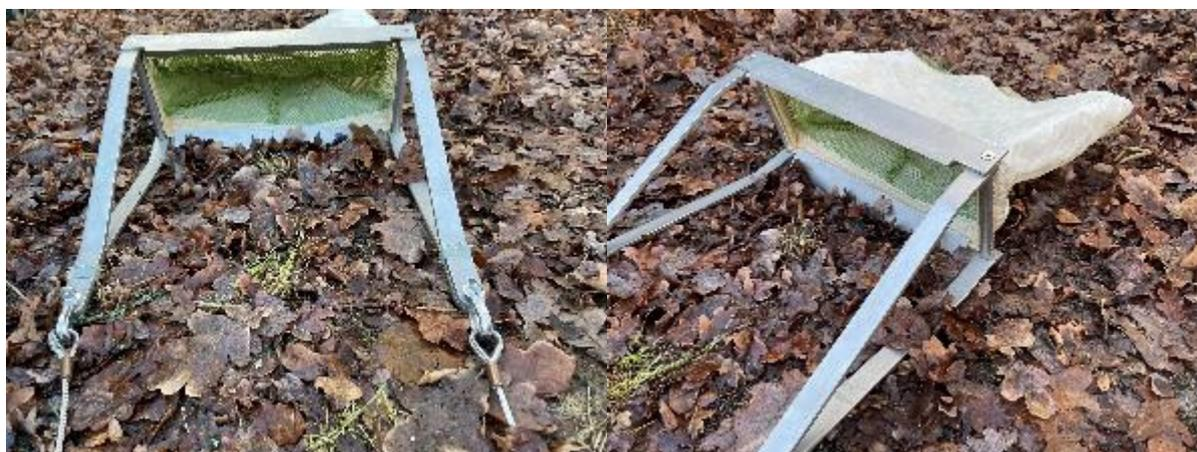
**Abb. 5:** Eingesetzte Bodendredge (Fa. Hydrobios, Kiel)
