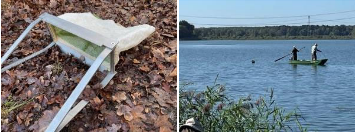
Abb. 4: Eingesetzte Bodendredge (Fa. Hydrobios, Kiel; links), Einsatz der Bodendredge vom Boot (rechts)
