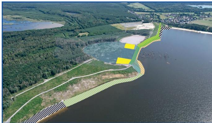
Vorzugsvariante zur Sicherung des Rutschungskessels im Bereich G-Nord/S-Süd
