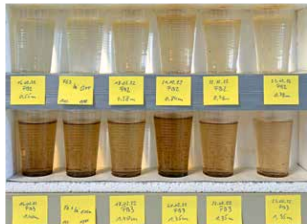
Probennahmen aus den Förderbrunnen der Grundwasserreinigungsanlage
